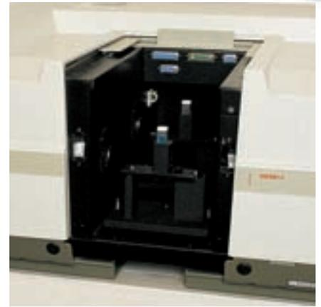
**Figura 16.** La fotografía muestra un espectrofotómetro ultravioleta/visible.
