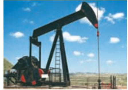
**Figura 7.** Explotación de yacimientos de petróleo. Un pozo petrolífero se puede encontrar entre los 2.000 y 3.000 m, e incluso hasta a 7.000 m de profundidad.
